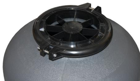
Die Befüllung erfolgt über diesen Ring mit zunächst mit 50 kg (zwei Beutel) Grobgranulat. Anschließend werden ca. 35 kg (ca. 1,5 Beutel) Feingranulat nachgefüllt. Nach Lösen der Schrauben an den Anschlussklemmen erfolgt die Abnahme des Spezialringes.
